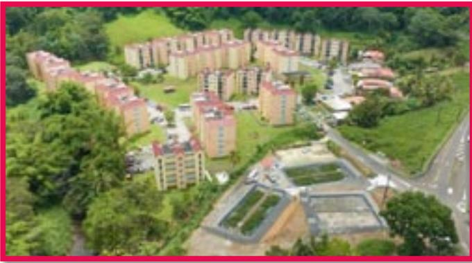
**La 1<sup>ère</sup> et la plus grande station d'épuration privée en filtres plantés avec le dispositif rhizosphair pour faciliter l'épuration des effluents par une aération forcée.**
